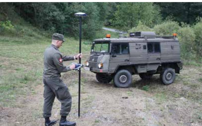
*Ein Soldat des Vermessungstrupps von GeoOps beim Kalibrieren des SP80 Vermessungssystems. Im Hintergrund befindet sich das geländegängige Vermessungsfahrzeug des IMG des Typs Pinzgauer. (Foto: IMG)*
